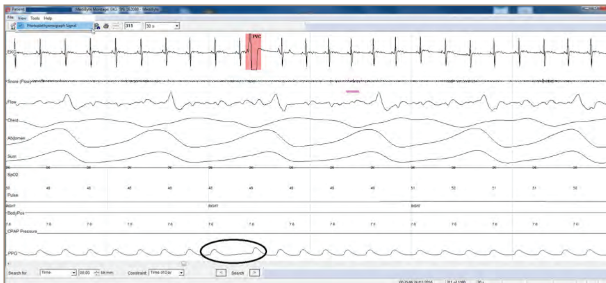
Figura 6.28: PVC sul segnale PPG ed ECG
