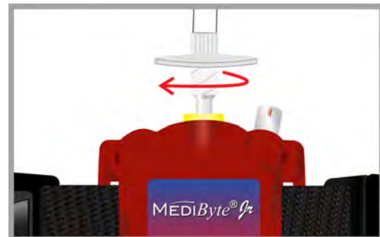
Abbildung 4.4: Den Druckfilter an den Druckkanülenanschluss anschließen
